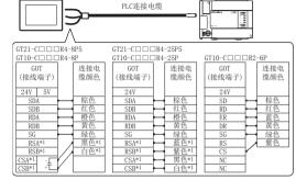
\*1 GT2103-PMBD用电缆没有向信号名(RSA、RSB、CSA、CSB)的连接。 连接某些PLC时需要自制电缆。 详情请参考G0T2000系列连接手册。
