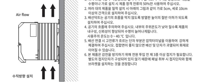
1. 위의 그림처럼 수직방향으로 설치하여 주십시오. 부득이한 상황에서 제품을 수평이나 가로 설치 시 제품 정격 전류의 50%만 사용하여 주십시오.
